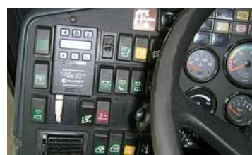
Ovládací panel může ukazovat rozdíl tlaků před filtrem a za ním, v případě překročení běžné meze se rozsvítí optická výstraha. Pokud řidič nezareaguje, následuje zvukový signál.
